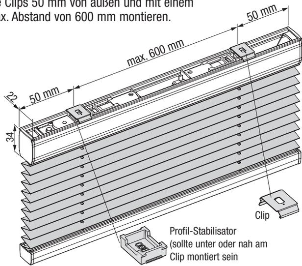
**Hinweis:** Der Clip wird vorzugsweise mit der Lasche nach vorn (Sichtseite) montiert.
